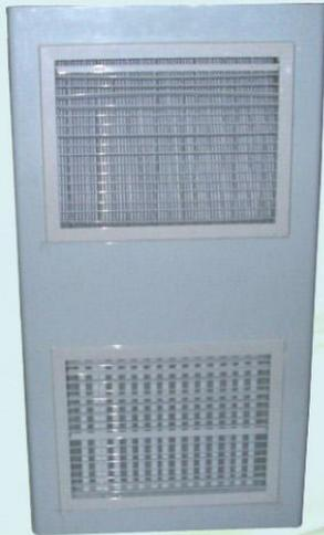
空气自净器是一种提供局部洁净工作环境的空气净化单元，由初效、风机、高效过滤器及静压箱组成。且带有风速可调器，可根据实际情况进行风速调动。净化级别出风口可达千级。震动小，结构简单，使用方便，是简易小面积需空气净化的最佳理想净化设备。现在广泛应用于小面积如电子厂房、生物医药、无菌室、实验室，纯净水、灌装水厂灌装间，饮料厂，食品厂、酒厂、保健品厂、奶制品厂的空气净化。
