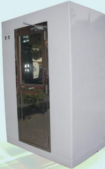
风淋/货淋室是人员及货物进入洁净室无尘车间所必备的净化设备，通用性强，可与所有的洁净室和洁净厂房配套使用，工作人员及物品进入车间时，必须通过此设备，用强劲洁净的空气，由可旋转喷嘴从各个方向喷射至人或物品身上，有效而迅速清除附着在衣服上的灰尘、头发、发屑等杂物，它可以减少人员及物品进出洁净室所带来的污染问题。风淋室的两道门电子互锁，可以兼起气闸室的作用，阻止外界污染和未被净化的空气进入洁净区域。杜绝工作人员将头发、灰尘、细菌等杂物带入车间，达到工作场地严格的无尘净化标准，生产出高质量的产品。
